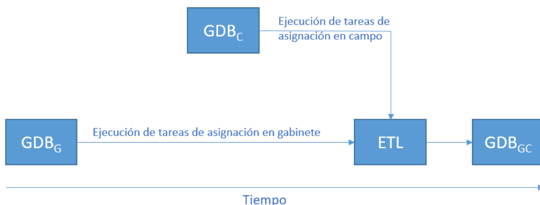
Figura 1. Proceso de volcado de datos de la geodatabase de campo (GDB C ) a la geodatabase de gabinete (GDB G ) en otra geodatabase (GDB CG ) mediante un programa de migración de datos ETL (del inglés, Extract, Transformation and Load). Fuente: elaboración propia.
