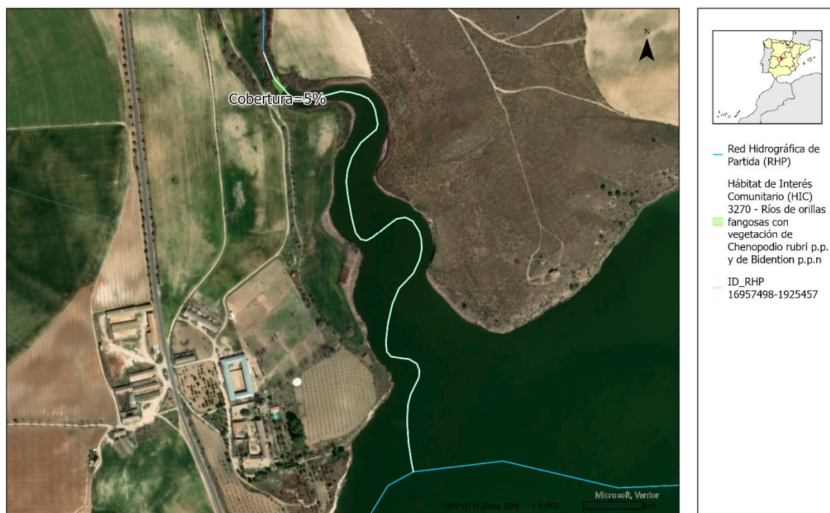
Figura 12. Ejemplificación del tipo de solape "caso 4" entre el tramo de la Red Hidrográfica de Partida (RHP) (en color azul) y la cartografía auxiliar (en color verde). Fuente: elaboración propia.
