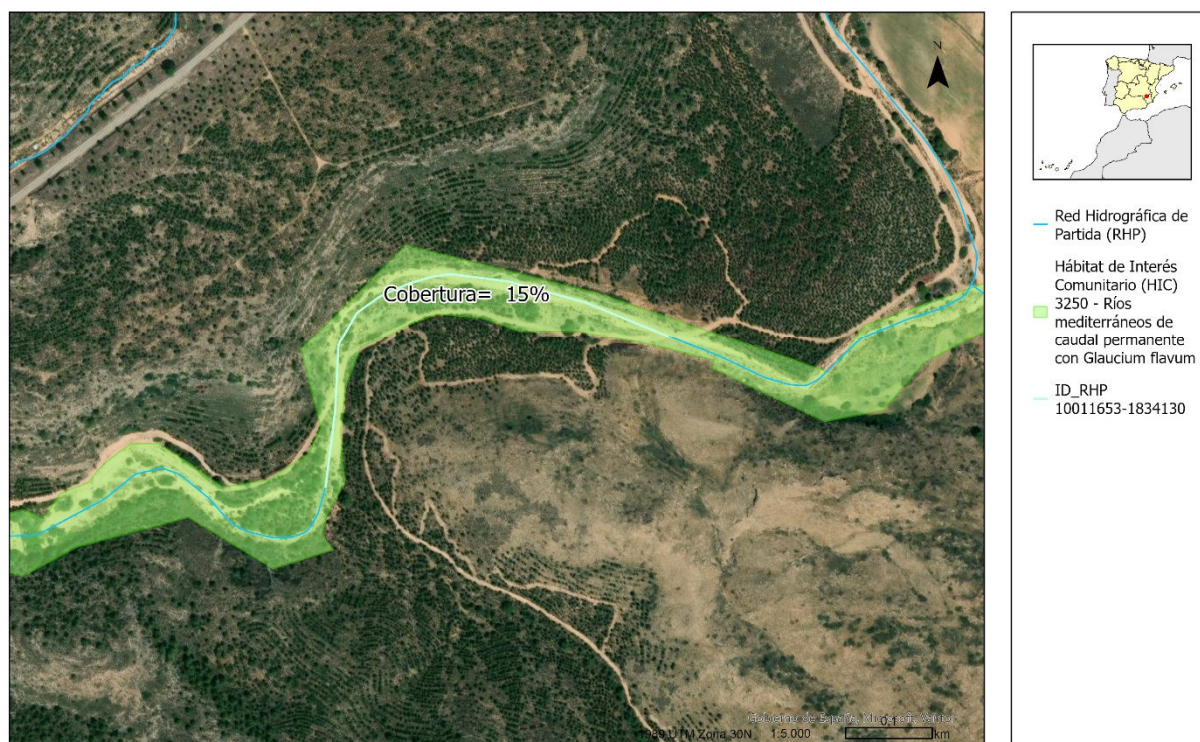
Figura 11. Ejemplificación del tipo de solape "caso 3" entre el tramo de la Red Hidrográfica de Partida (RHP) (en color azul) y la cartografía auxiliar (en color verde). Fuente: elaboración propia.
