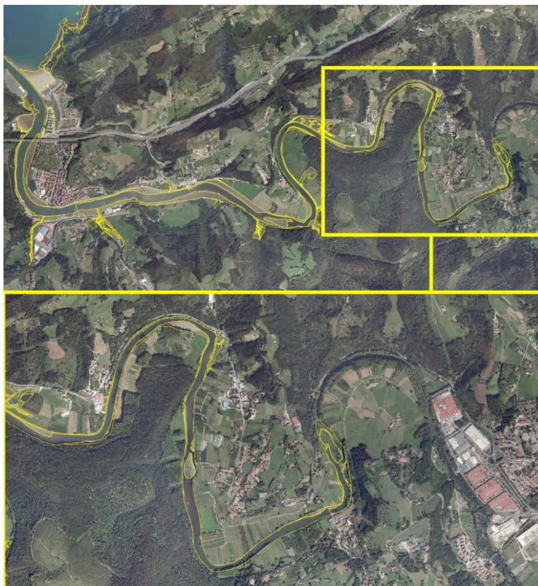
Figura 13. Digitalización y límite interior establecido en el estuario del río Oria, provincia de Guipúzcoa. En él se aprecia una reducción súbita de la anchura del canal, desaparición de barras de arena y un claro cambio de vegetación de marisma hacia un bosque de ribera. Fuente: elaboración propia a partir de los polígonos del Mapa Forestal de España (MFE25).
