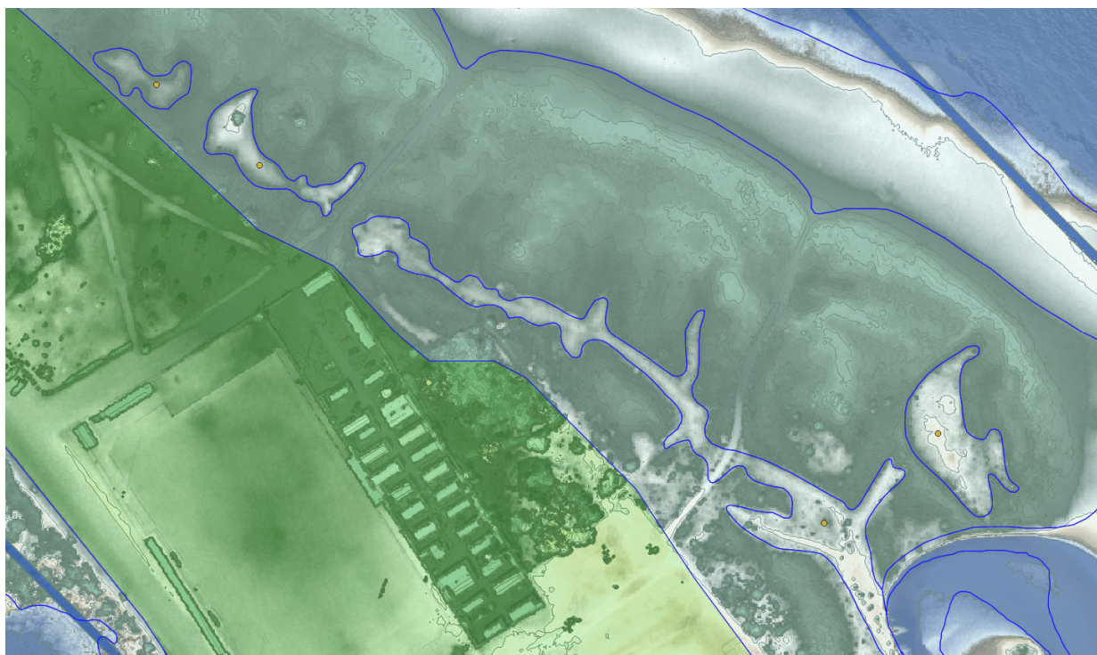
Figura 14. Modelo Digital del Terreno (MDT) utilizado para la delimitación de las depresiones interdunares en el sistema dunar de Noja, Cantabria. Depresiones interdunares marcadas con puntos naranjas sobre el polígono. Fuente: elaboración propia a partir de proyecto Light Detection and Ranging (LiDAR) - Plan Nacional de Ortofotografía Aérea (PNOA).
